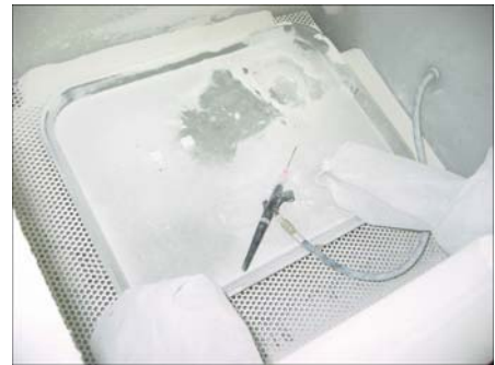
Abb. 5-24 – RP – Pulver entfernen
