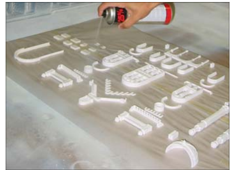
Abb. 5-26 – Spraysen mit Autolack
