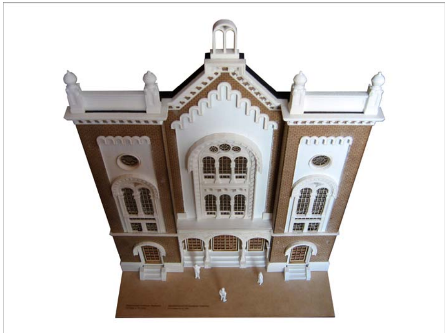
Abb. 5-32 – RP-LC-Modell – Übersicht Frontfassade M 1:50
