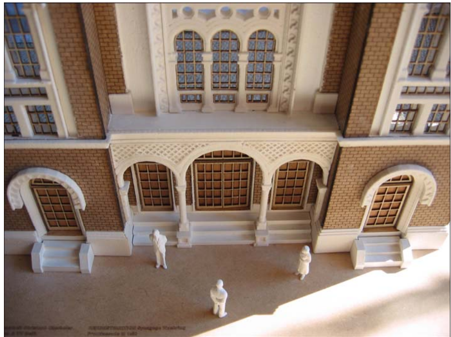
Abb. 5-33 – RP-LC-Modell – Frontfassade 1 M 1:50
