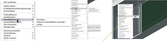
**Schritt 1** erzeugen sie ein Massenelement "Quader" aus dem **W** Modellieren. Klicken sie auf die Zeichenfläche und geben sie als Masse im Textfeld Dialog für die Höhe 2.2m ein. Klicken sie auf das Bauteil und korrigieren sie die Dimension ( Hilfe TABtaste ) auf Länge 2.54, Tiefe 0.25, Höhe 2.2. Verschieben sie das Bauteil (KRM, Textfeld) auf die Position x - 2,4414 y - -0,025 z- 0,000
