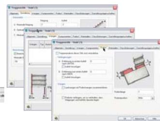
Manche Typen von Konstruktionselementen und Objekten werden als Instanzen vordefinierter Elemente aus Bibliotheks Dateien eingefügt. Diese externen Dateien werden parametrisierbare Objekte genannt. Diese Parameterobjekte (auch als intelligente-Objekte oder Bibliothekselemente bezeichnet) werden in Bibliotheken gespeichert und können in zahlreichen Projekten verwendet werden. Viele sind einem eigenen Werkzeug im Werkzeugkasten zugeordnet.
