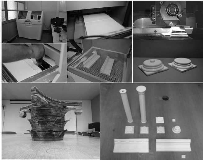
Imagem 3 – protótipos fabricados nas diferentes técnicas, nomeadamente impressão 3D Zcorp e FDM, modelo produzido na cortadora a laser. Finalmente um conjunto de peças fabricadas que através de um sistema de encaixe permite demonstrar a sistematização da coluna de Alberti.
